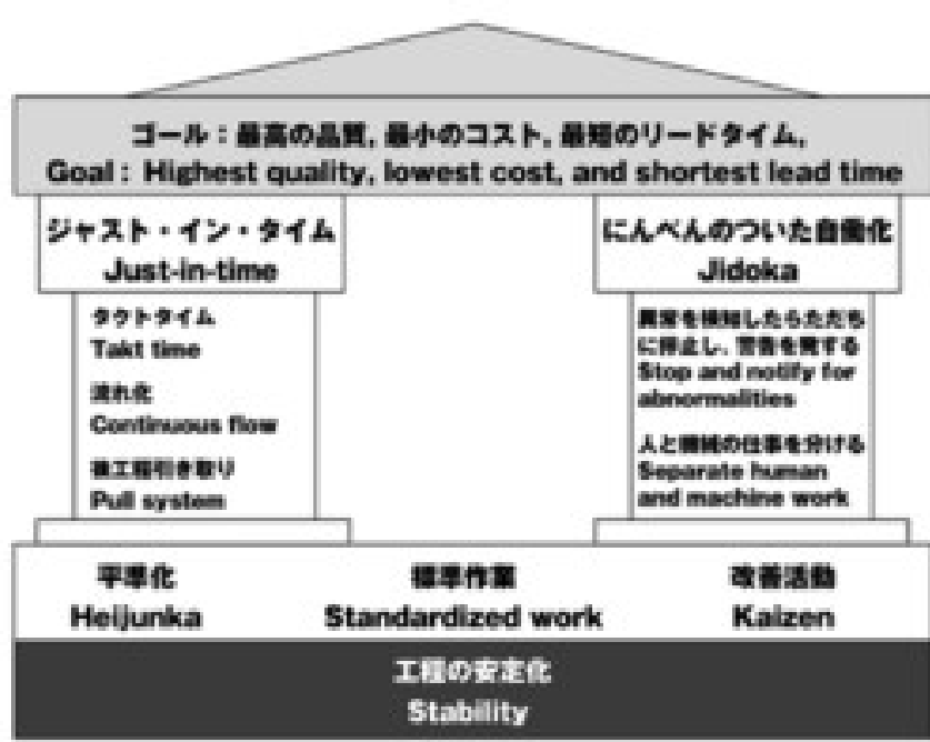
トヨタ生産方式の基本のイメージ：TPSハウス Basic Image of the Toyota Production System: the TPS House
